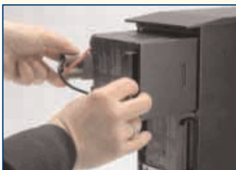
Упрощенная процедура "горячей" замены батареи
